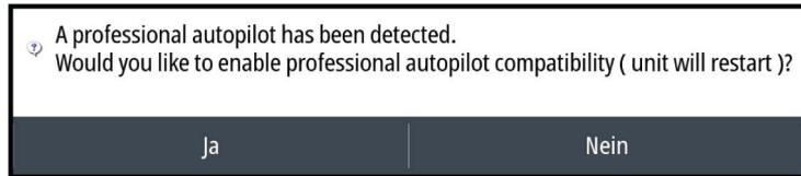
Wenn Ja (Yes) ausgewählt wird, wird das MFD unter Verwendung des gleichen Quellengruppensatzes wie für das AP70/AP80-System neu gestartet. Wenn Nein (No) ausgewählt wird, wird die Frage nicht erneut gestellt und das MFD kann nicht zur Bedienung der AP70/AP80-Systeme verwendet werden.
